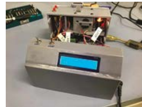
Figura 1. Dispositivo per la misura dei tannini in vino e matrici alimentari, realizzato da Perceptron Network (Cesena, IT) su specifiche fornite dai ricercatori del DISTAL– Università di Bologna
